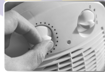
Isıtıcıların fan hızı ve sıcaklık ayar düğmesi reosta özelliğine sahiptir.
