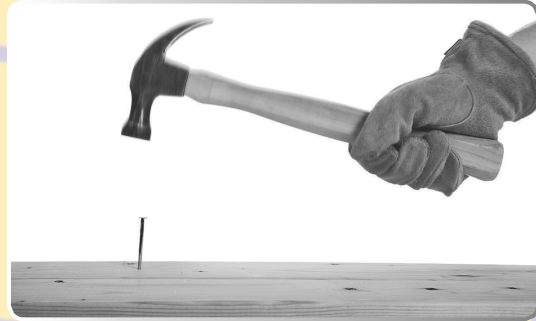
Çekicinin sahip olduğu potansiyel ve kinetik enerjilerin toplamı (mekanik enerji) çivi üzerinde iş yapar.
