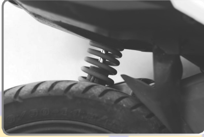
Bir motosikletteki amortisör (yay) sıkışıp gerilerek esneklik potansiyel enerjisi depolar.
