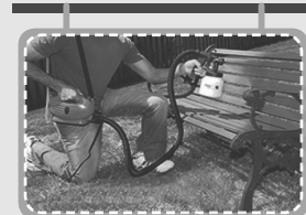
Boya tabancalarındaki sıkıştırılmış hava, itici gazdır.
